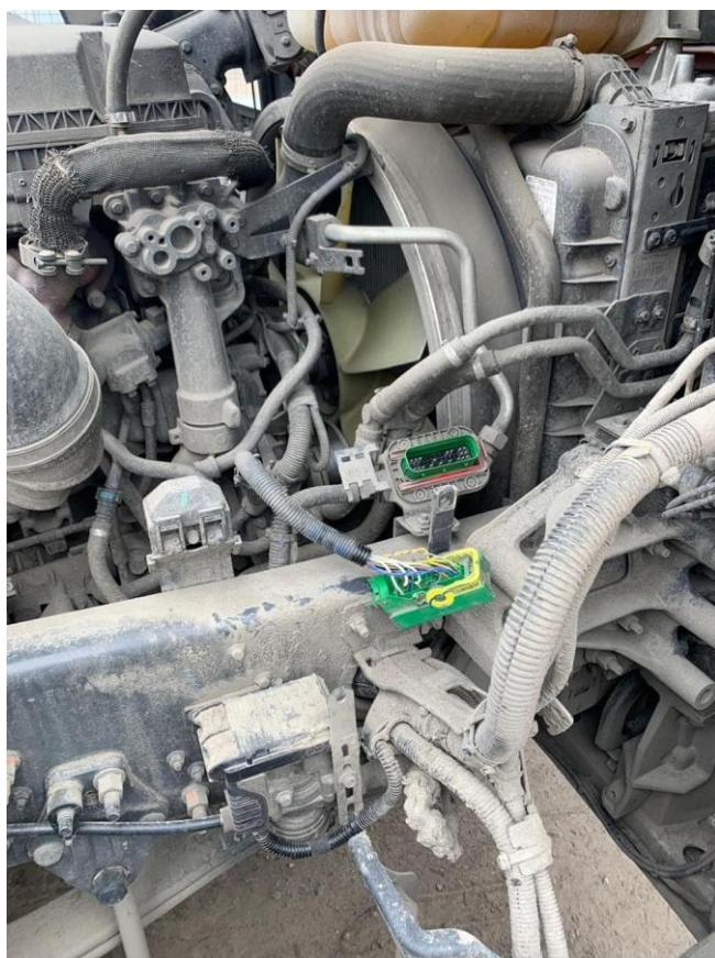
(!) Очень важно аккуратно проложить CAN шину от эмулятора до разъема на раме у двигателя, постоянно фиксируя пластиковыми хомутами-стяжками, чтобы ее не перетерло и не повредило спустя время. Рекомендуем защитить CAN шину термоусадочной трубкой и упаковать в пластиковую гофру для большей надежности.
